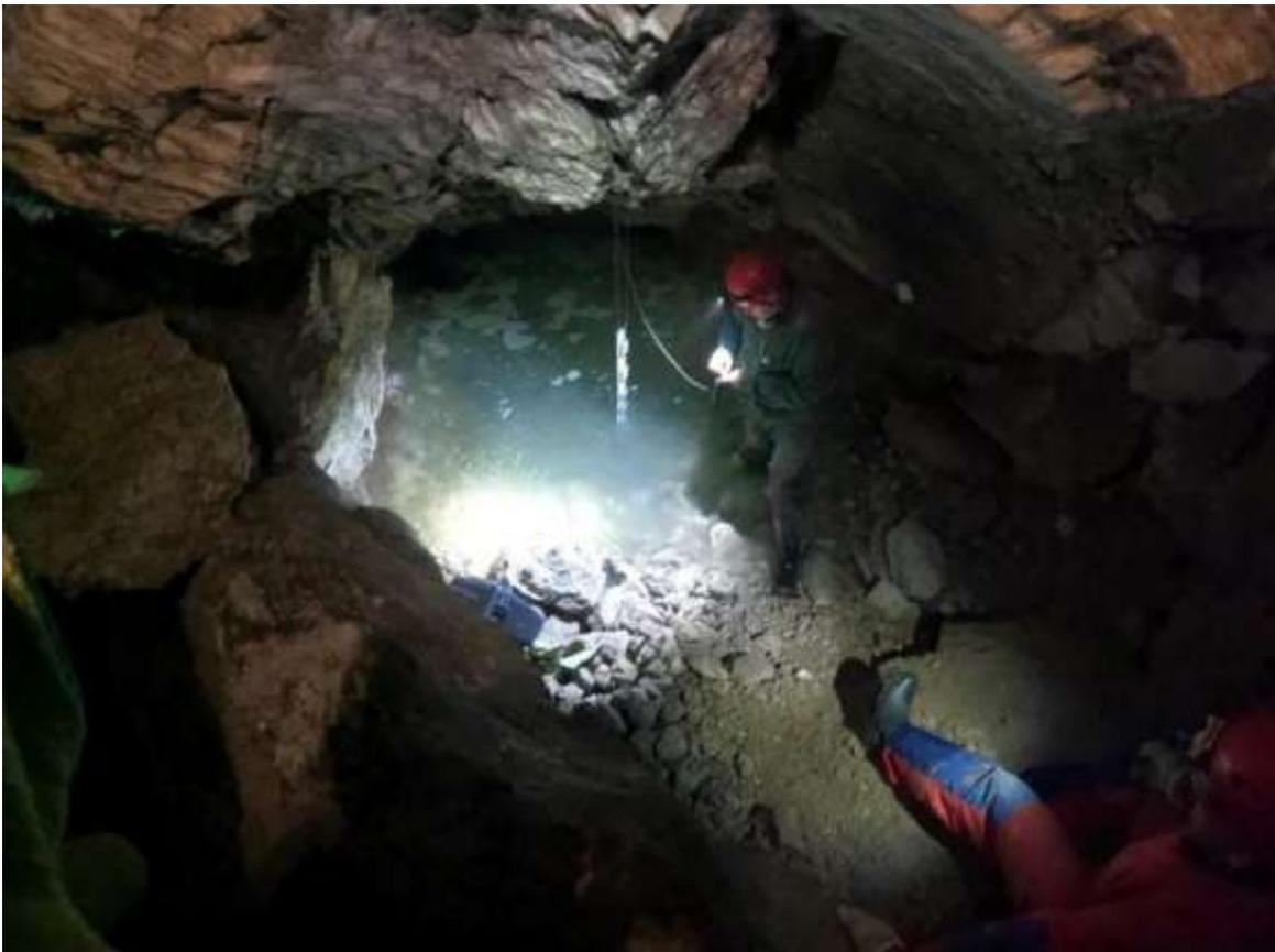
*Am Ablaufponor der Questenhöhle mit der Pegellatte und einem Pegellogger. Der Höfo rechts sitzt auf der instabilen Einbruchhalde, die vom Wasser des Ponors stark unterströmt und dadurch auch intensiv gelaugt wird. (Foto: Frank Kleeblatt)*
