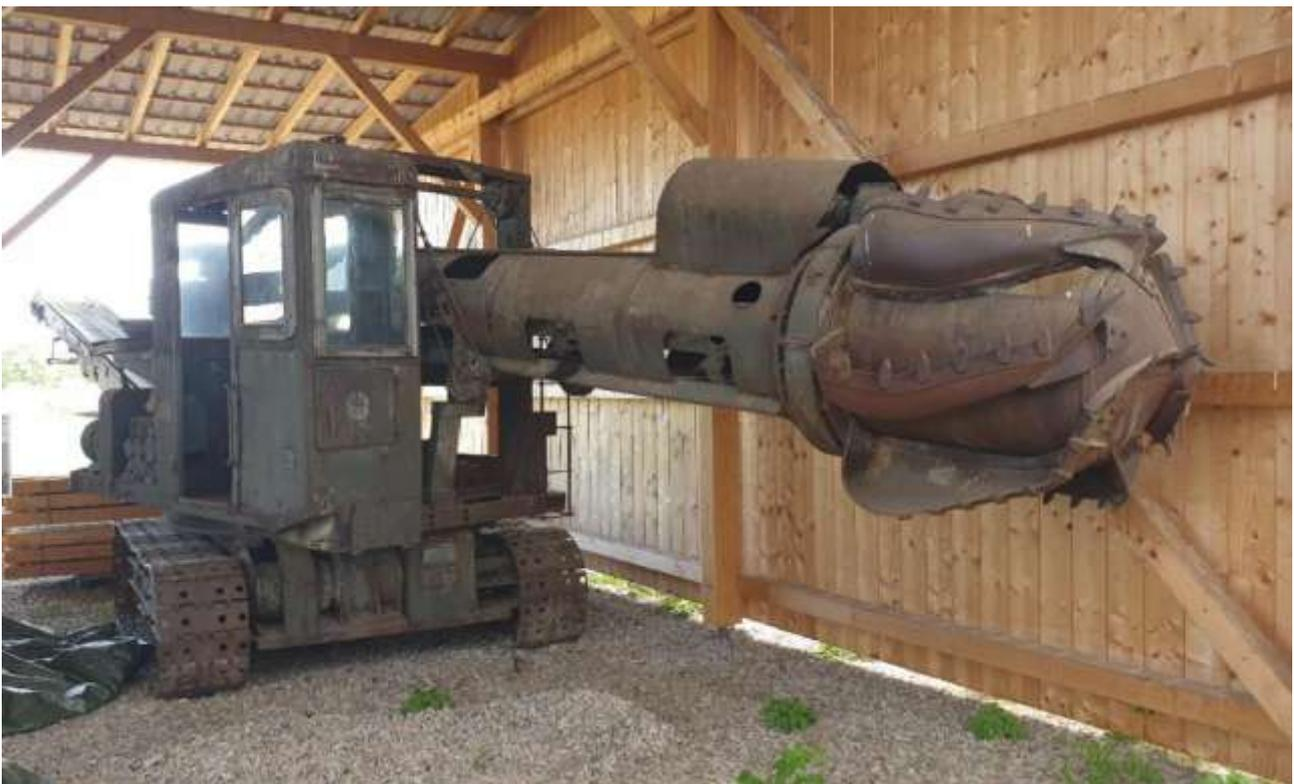
*Kohlefräse in der Zuckerfabrik Oldisleben. Die per Eisenbahn angelieferte Braunkohle für das Heizwerk musste auf der Deponie mit einer Planierraupe verdichtet werden, damit sie sich nicht selbst entzündet. Dadurch war sie aber so hart, dass sie vor dem Verheizen wieder mit diesem schweren Gerät gelockert werden musste (Foto: Hartmut Simmert).*
